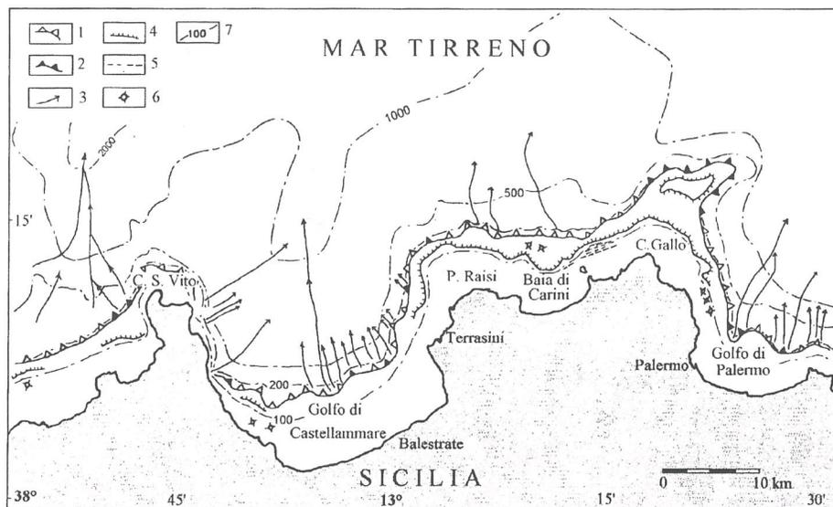
Fig. 5 — Schema morfologico della piattaforma continentale. 1) bordo della piattaforma continentale; 2) bordo della piattaforma continentale in arretramento; 3) canyons; 4) rottura di pendio concava; 5) beach rocks; 6) rilievi isolati; 7) linee batimetriche (metri).
